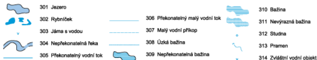
Obr.: Vodstvo podle normy ISOM 2000
