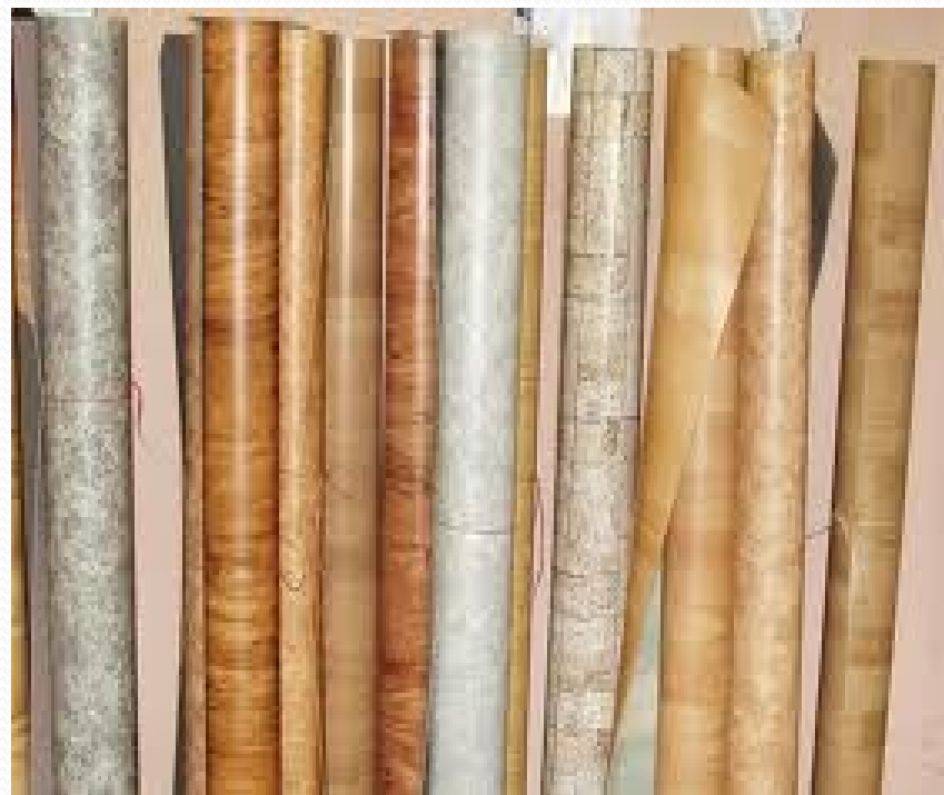
Obr. 3.: Podlahové krytiny z PVC.
