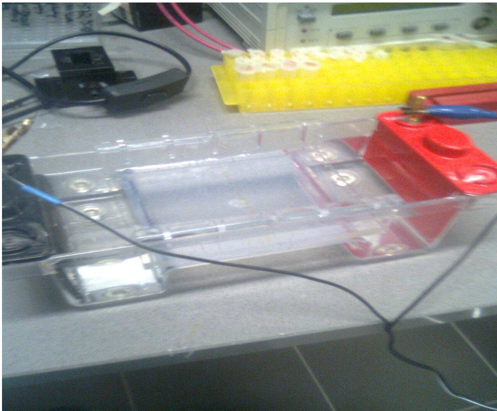
Obrázek 8: Aparatura s gelem i tlumivým roztokem připojená ke zdroji stejnosměrného napětí
