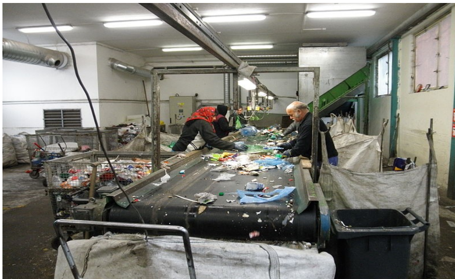
Obr.3.: Separační linka pro ruční třídění plastového odpadu.
