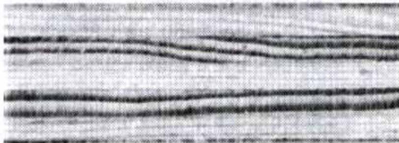
Obr.10.23. Jeden z nejnámějších laminárních kompozitů – dřevěná překližka.
