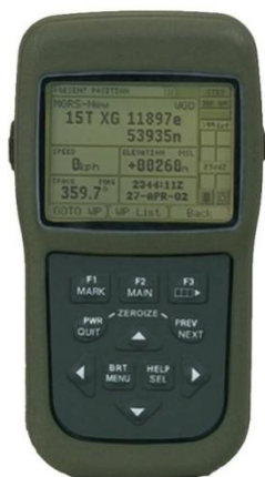
Obr. 5-19 Vojenský přijímač GPS typu DAGR firmy Rockwell Collins
