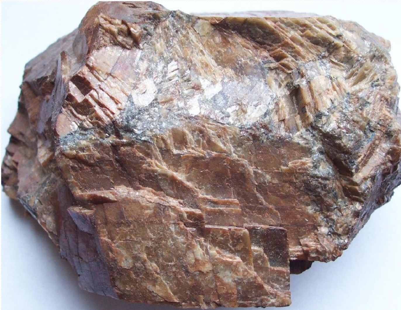
Obr. 5.: siderit ( \text{FeCO}_3 – uhličitan železnatý)
