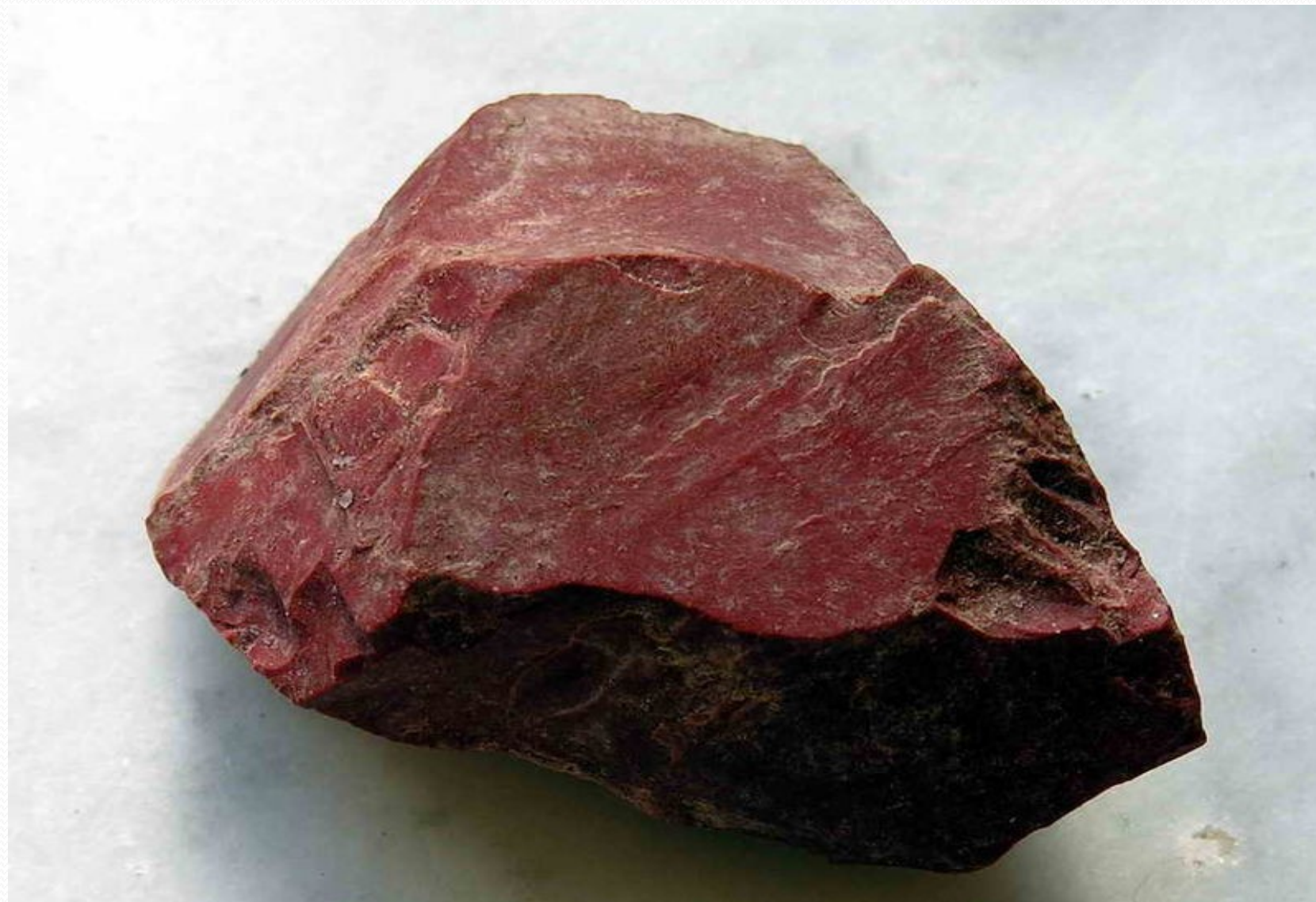
Obr. 3.: hematit ( \text{Fe}_2\text{O}_3 - oxid železitý)
