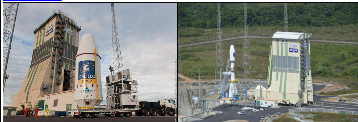
Obr. 9: Svrchní část určená nosné rakety Sojuz obsahující družici systému Galileo (vlevo). Příprava k vnesení družice systému Galileo na oběžnou dráhu s použitím rakety Sojuz (vpravo). Zdroj http://www.esa.int/
