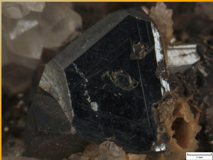
Krystal tetraedritu ve spojení dvou tetraedrů a hexaedru, typický kovový lesk.
