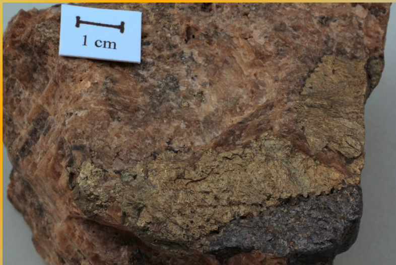
Tmavě žlutý, celistvý agregát chalkopyritu, Příbram.
