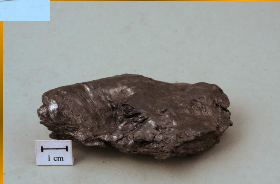
Masivní agregát velmi čistého grafitu s polokovovým leskem, Český Krumlov.
