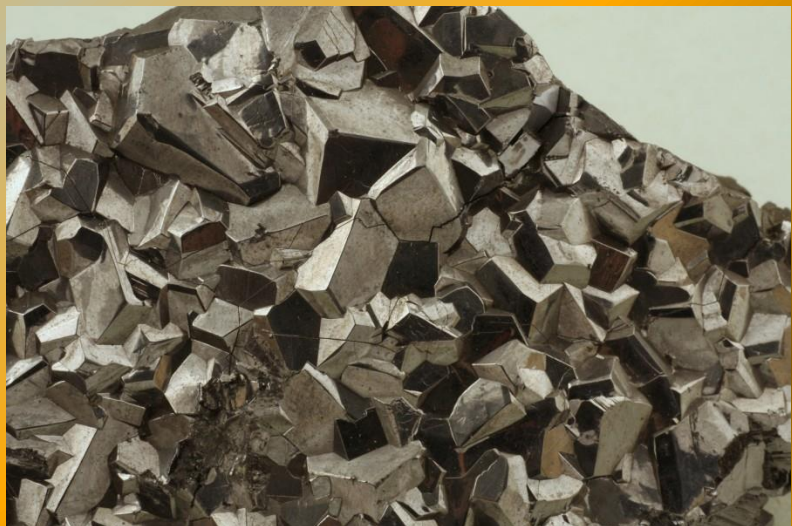
Krystalovaný galenit s ocelově šedou barvou a kovovým leskem, Příbram.
