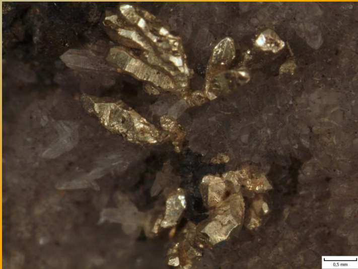
Nedokonalé krystalky zlata s bledě žlutou barvou a kovovým leskem zarostlé v křemeni.
