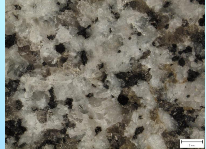
Všesměrně zrnitý granodiorit, bílá zrna plagioklas, šedá křemen, tmavá biotit, Slatina.
