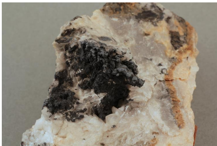
Obrázek 19. Shluk drobných, černých krystalů argentitu. Na některých ložiscích bývá důležitou rudou stříbra. Vzorek z ložiska Příbram.
