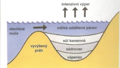
44 Vznik solného ložiska a chemických usazenin – schéma
