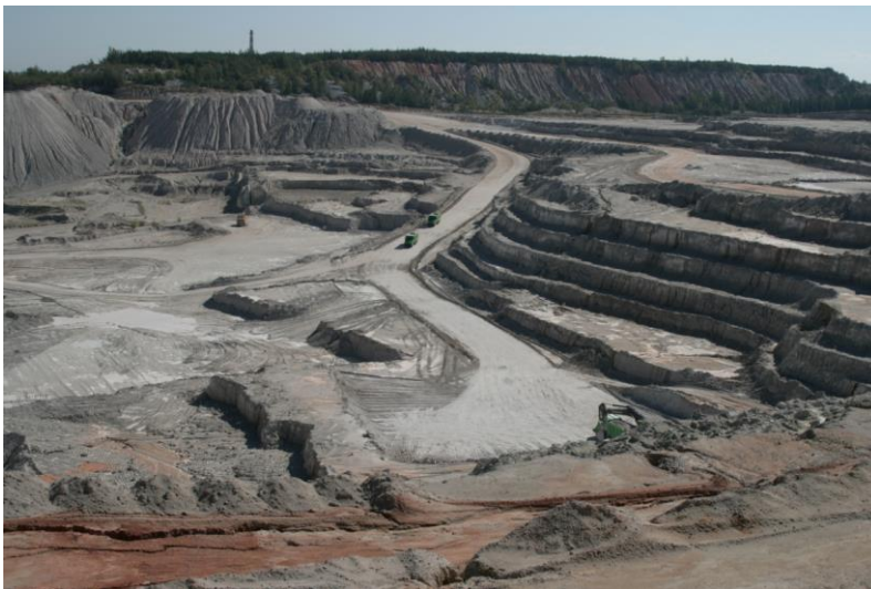
Obrázek 18. Ložisko Kaznějov u Plzně. Kaolinit zde vznikl zvětráváním živců karbonských arkóz.
