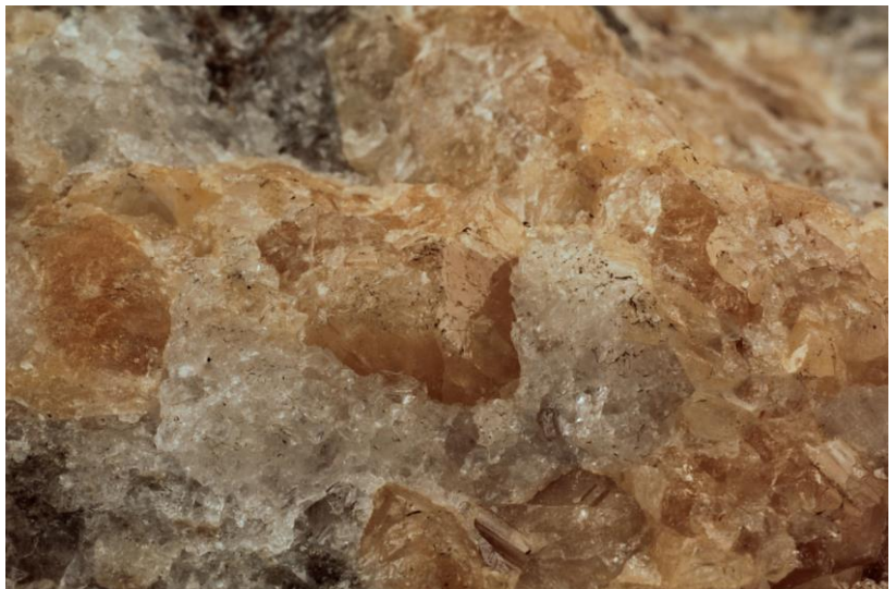
Obrázek 3. Žlutohnědý krystal scheelitu (zdroj W) ze skarnového tělesa Obří důl v Krkonoších.
