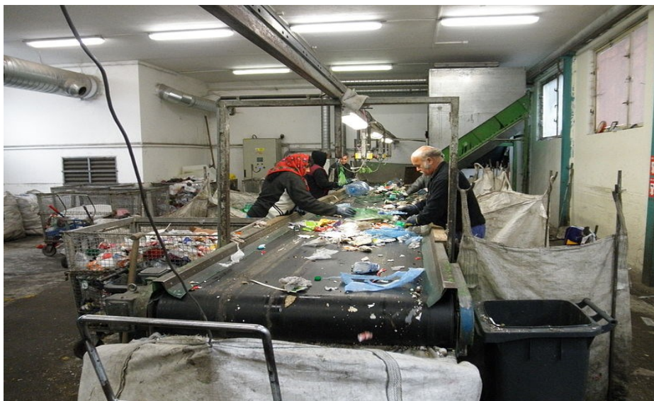
Obr.3.: Separační linka pro ruční třídění plastového odpadu.
