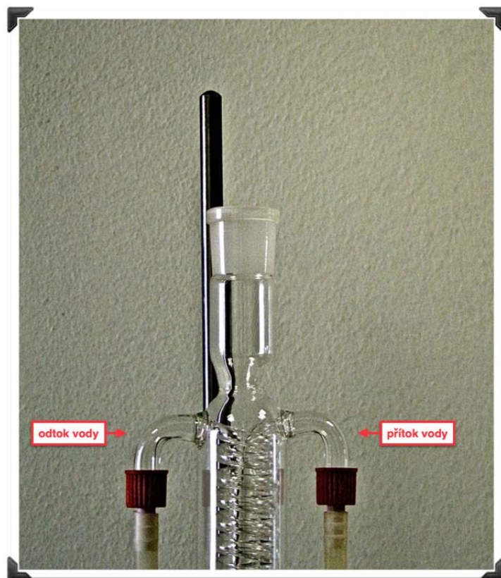
Obr. 42a. Uspořádání chladiče u reakce otevřené do vnější atmosféry.
