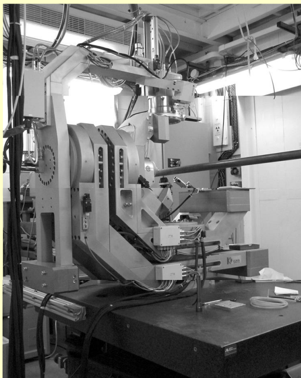
7-kruhový RTG difraktometr u synchrotronového zdroje ESRF v Grenoble
