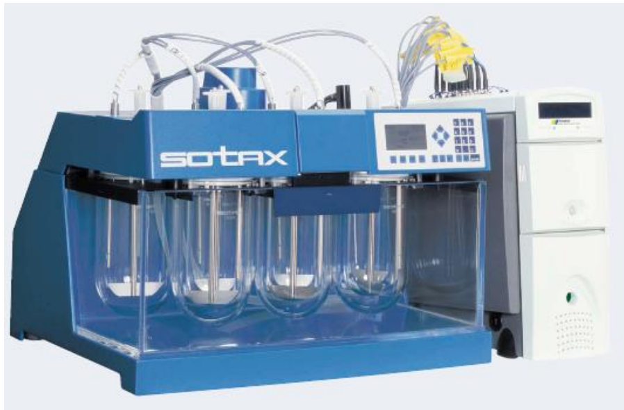
Disoluční přístroj Sotax AT 7 Smart s lopatkovým míchadlem
