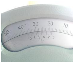
Příklad odečítání na stupnici =16,55°
