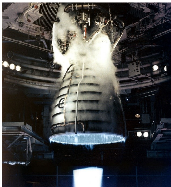
Motor raketoplánu (spalování vodíku)
