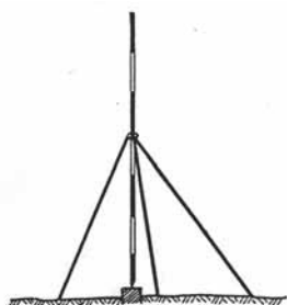
Přechodná signalizace výtyčkou Obr. 5.9
