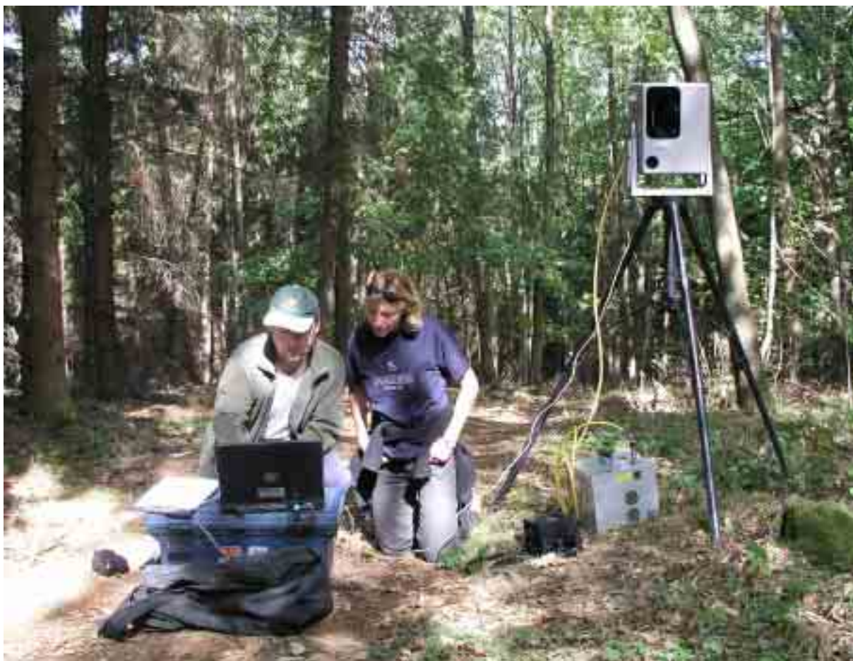
Obr. 1. Laserový scanner CYRAX 2500 v terénu. Foto D. Dreslerová.
