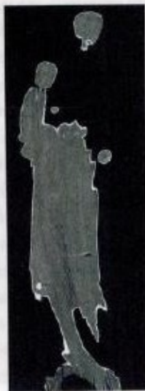
Počítačová tomografie a RTG snímek Madony z Klentnice. 1 – RTG snímek hlavy, viditelně kovové hřebíky, rozsáhlé tmely na vlasech a na ramenou; 2–6 – Počítačová tomografie: 2 – hlava (tangenciální řez), vsazený nos, suk na temeni hlavy; 3 – celek (topogram), viditelné kovové prvky; 4 – celek (tangenciální řez), čep v hlavě Ježíška, rozpadlé dřevě v dolní části; 5 – detail (axiální řez), nasazení levé ruky Madony na dřevěný čep; 6 – detail (axiální řez), nasazení pravé ruky Ježíška na dřevěný čep. / Computer tomography and an X-ray image of the Madonna from Klentnice. 1 – X-ray image of the head, visible metal nails, extensive areas of
