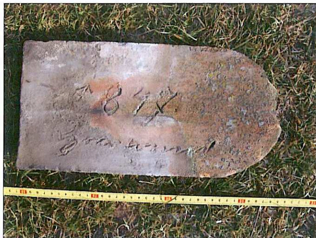
Obr. 25: Výšovice, kostel sv. Vavřince. Ručně formátovaná pálená režná půlkruhově zakončená taška bobrovka s nápisem a datací „1847“.
