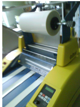
Laminace z role - lepení tenké fólie na papír teplem a tlakem
