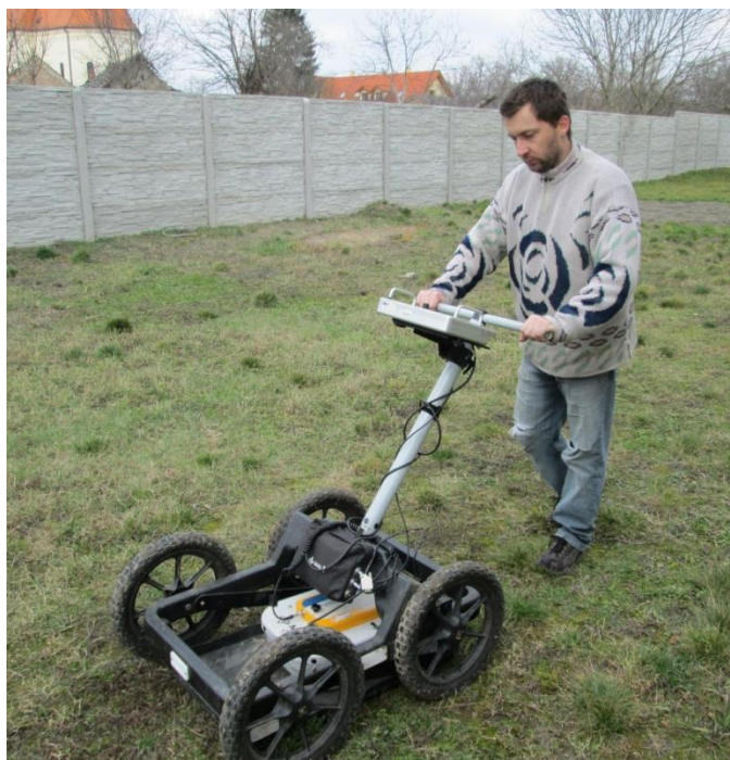
Obr. 1. Aparatura RAMAC X3M od švédské společnosti GEOSCIENE MALÅ (500 MHz anténa).
