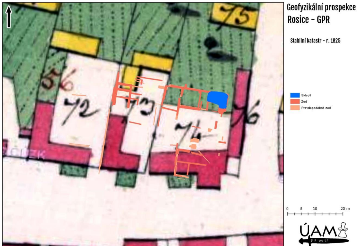
Obr. 20. Interpretace GPR průzkumu. Soubor architektur zaznamenaných v různých vertikálních úrovních na katastrální mapě z roku 1825.
