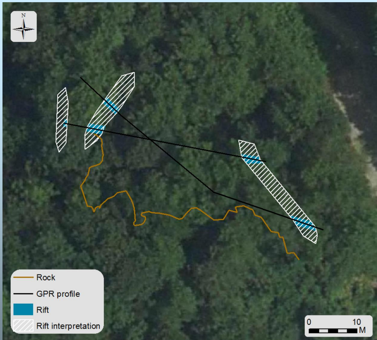
Výpustek. Poloha zaznamenaných tektonických puklín a ich predpokladaný priebeh na ploche pred bočným vchodom do jaskyne.
