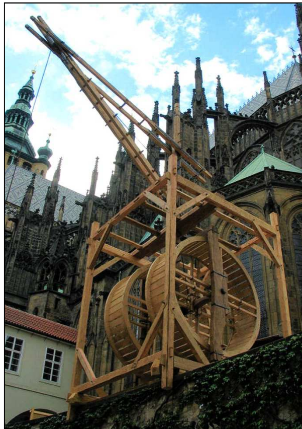
Mlázovského rekonstrukce stavebního jeřábu z doby Václava IV. na Točníku a na Pražském hradě
