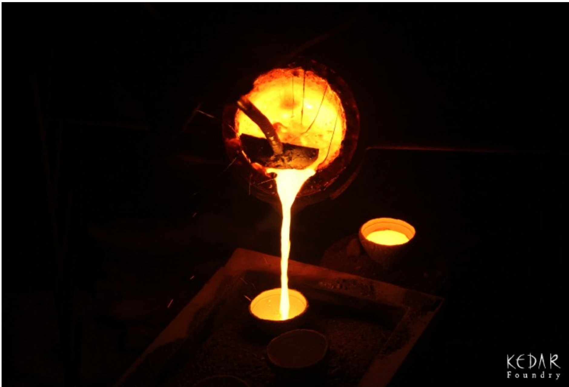
Obr. 2: Lití bronzu do keramických forem
