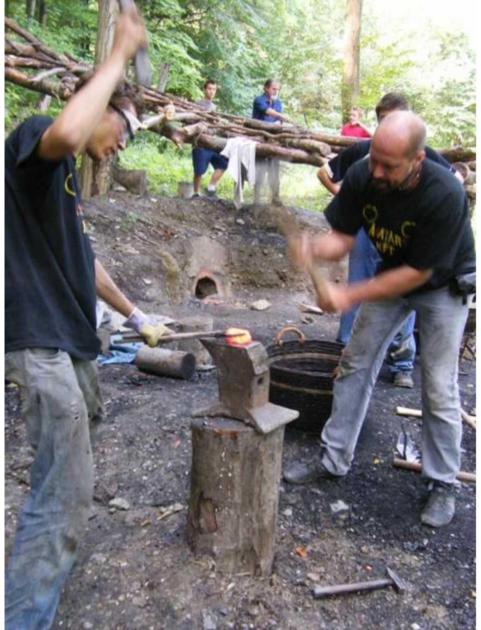
Smithing one of the iron blomms made in the Thiele's furnace Schmieden einer der Luppe aus der Thiele-Ofen
