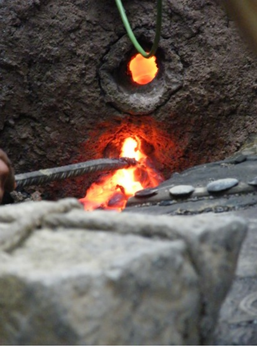
Slag tapping from the Thiele's furnace Schlackenabstich aus der Thiele-Ofen
