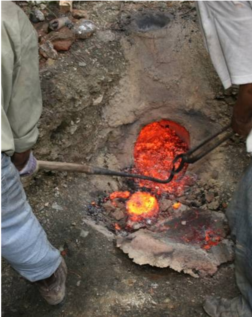
A kohó mellfalazatának nyitása, a buca kihúzása. A vassalak leverése a vasbucáról az újraizzítás előtt. / Opening of the furnace. Knocking down the slag from the iron bloom before the reheating. / Eröffnung der Brustwand des Ofens. Herunterschlagen der Schlacke von der Eisenluppe. (Gömöri-kohó / Gömöri's furnace)
