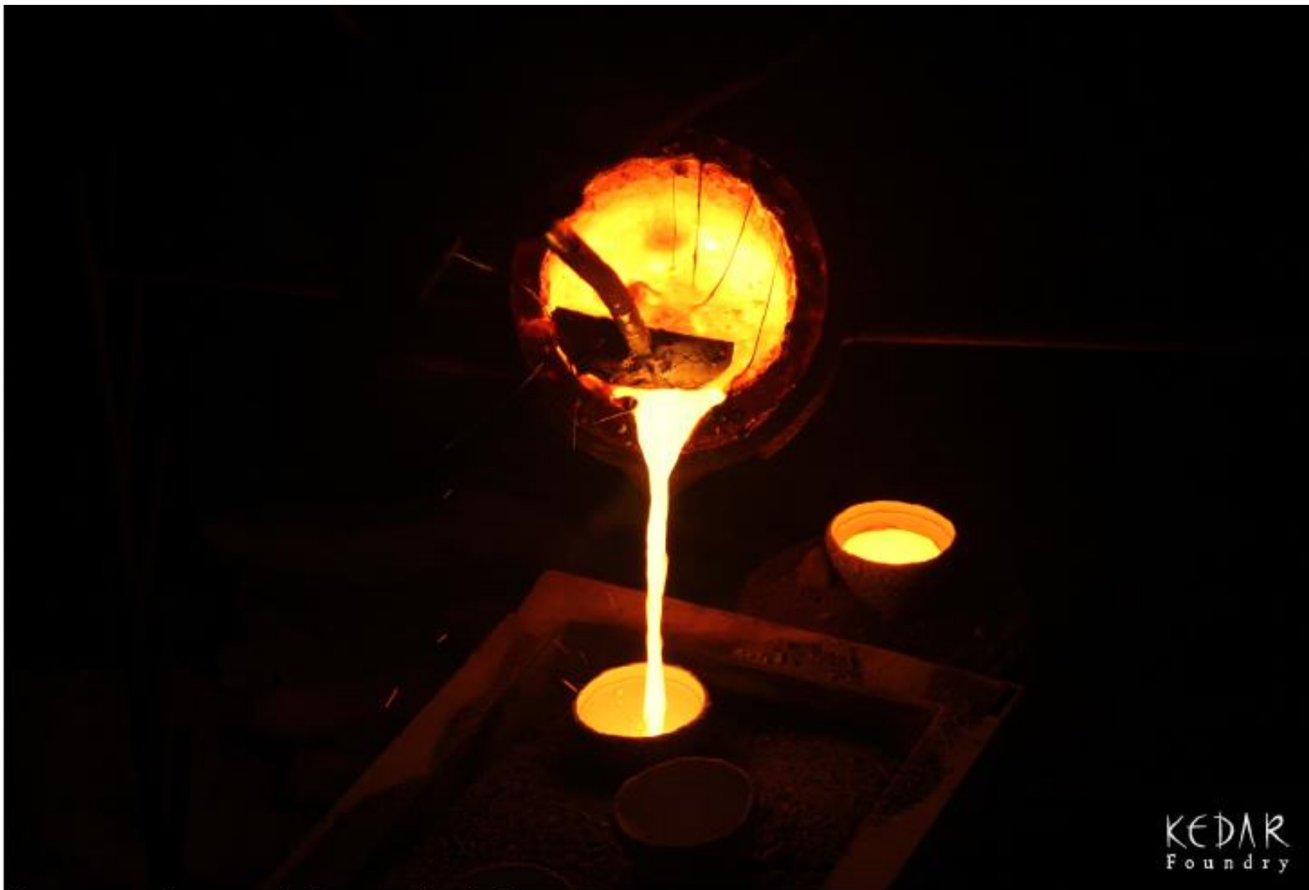
Obr. 2: Lití bronzu do keramických forem
