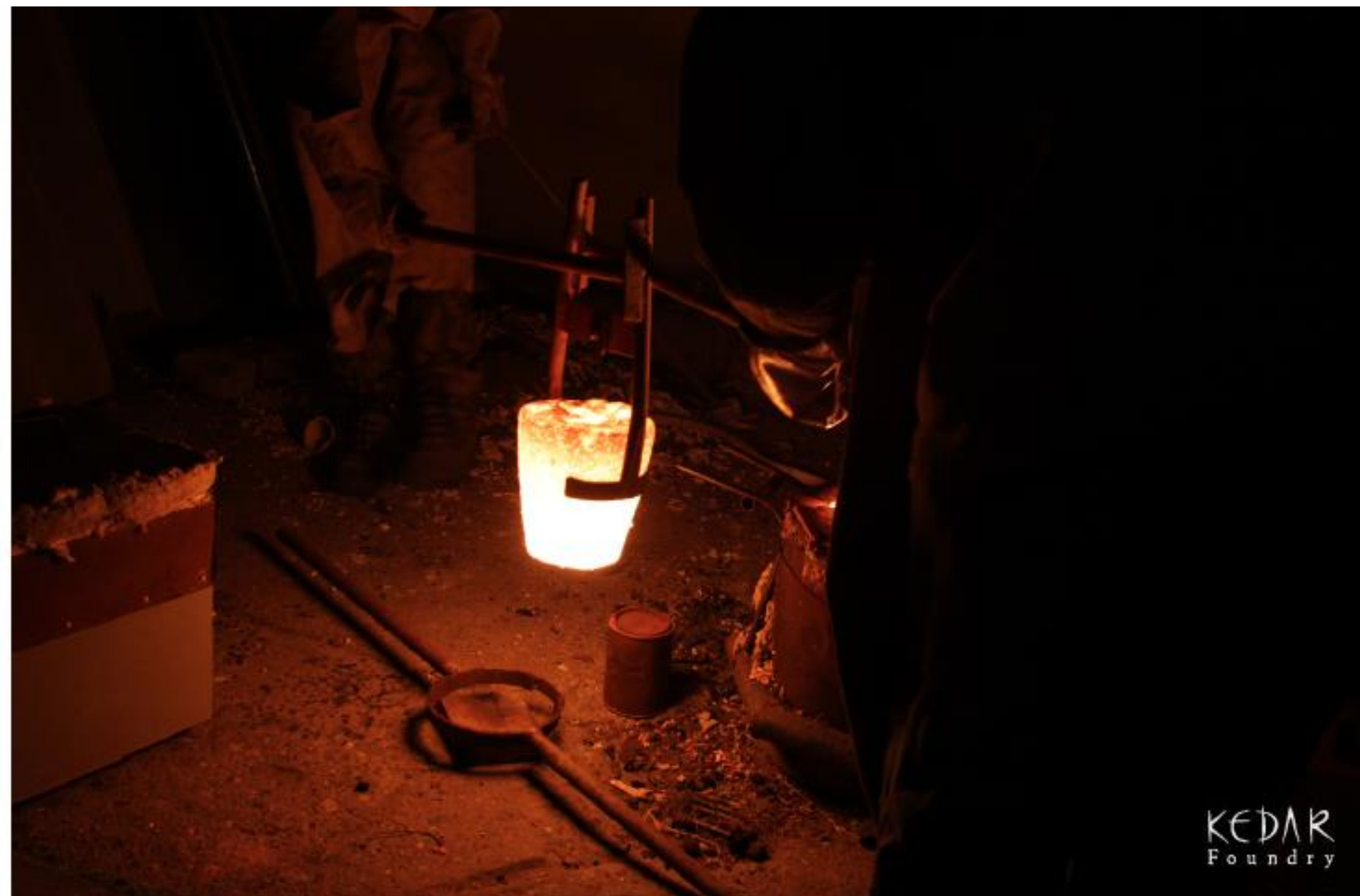
Obr.4: Vyjímání tavicího kelímku před umístěním do licího oka
