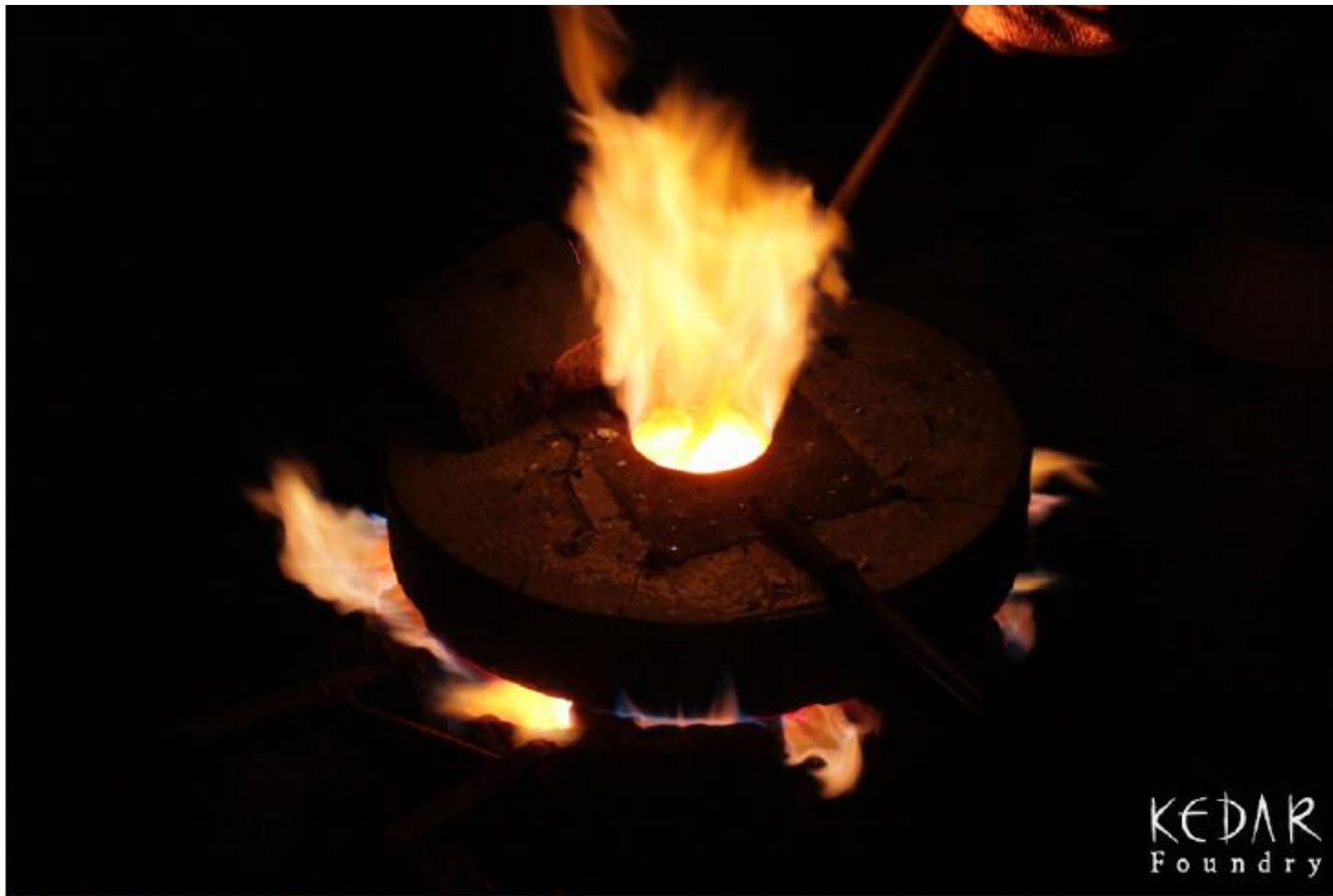
Obr. 3: Tavící pec na pevné palivo během tavby
