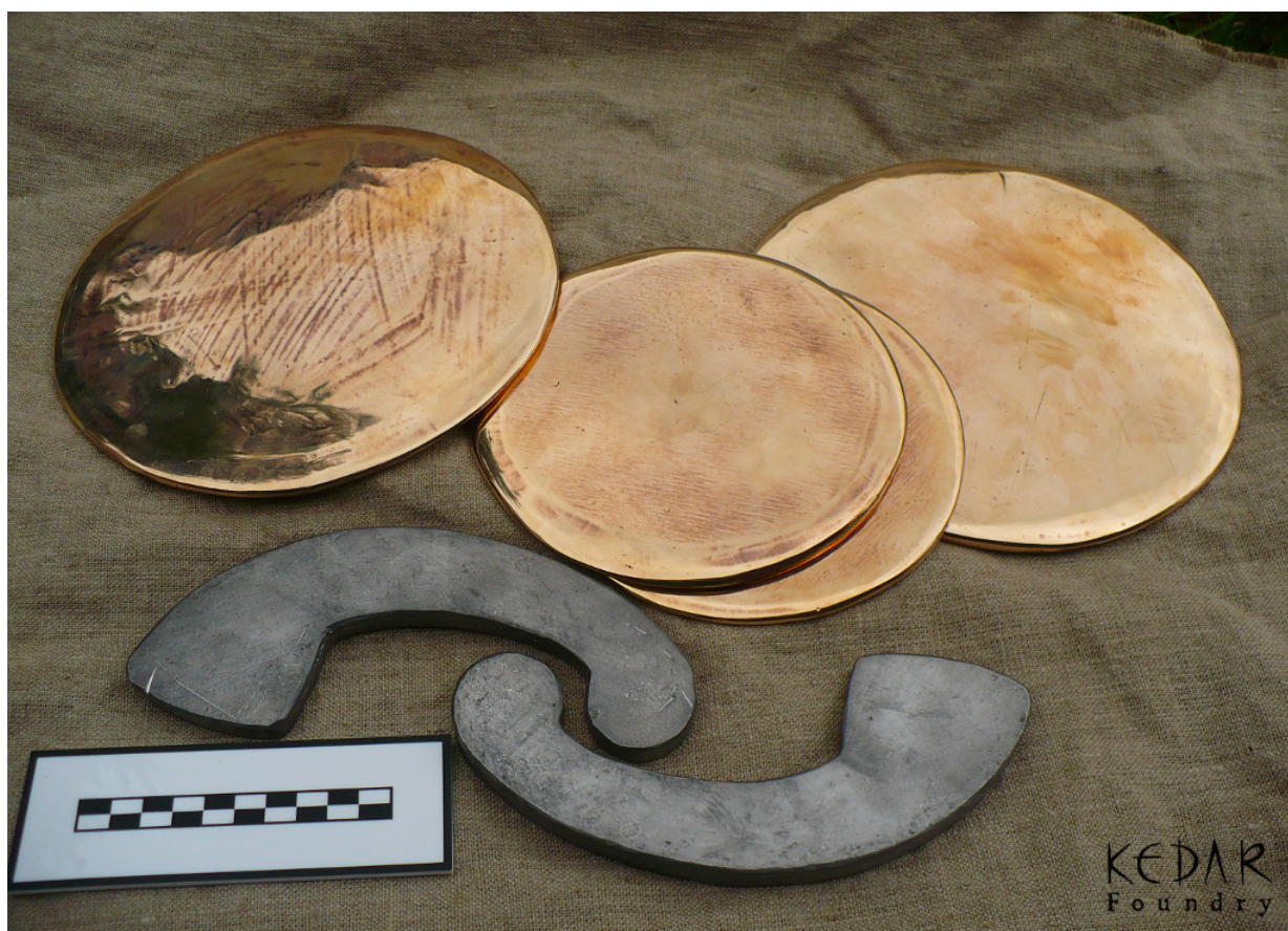
Obr. 5: Bronzové disky po cizelování a olověné haltéry
