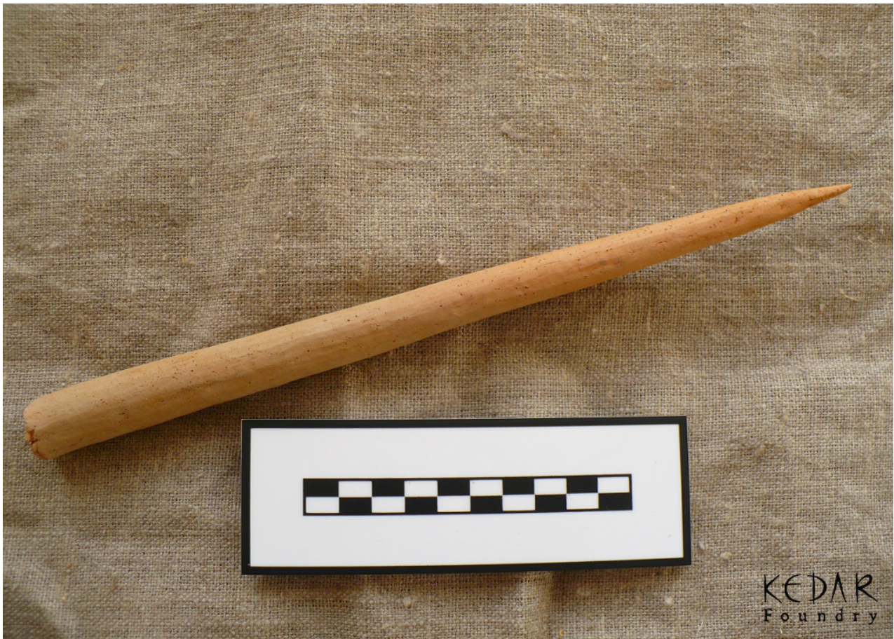
Obr. 7: Keramické jádro pro výrobu oštěpu po výpalu v peci při teplotě 800 °C
