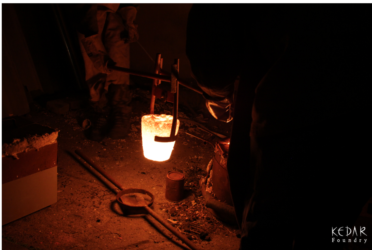
Obr.4: Vyjímání tavícího kelímku před umístěním do lícího oka
