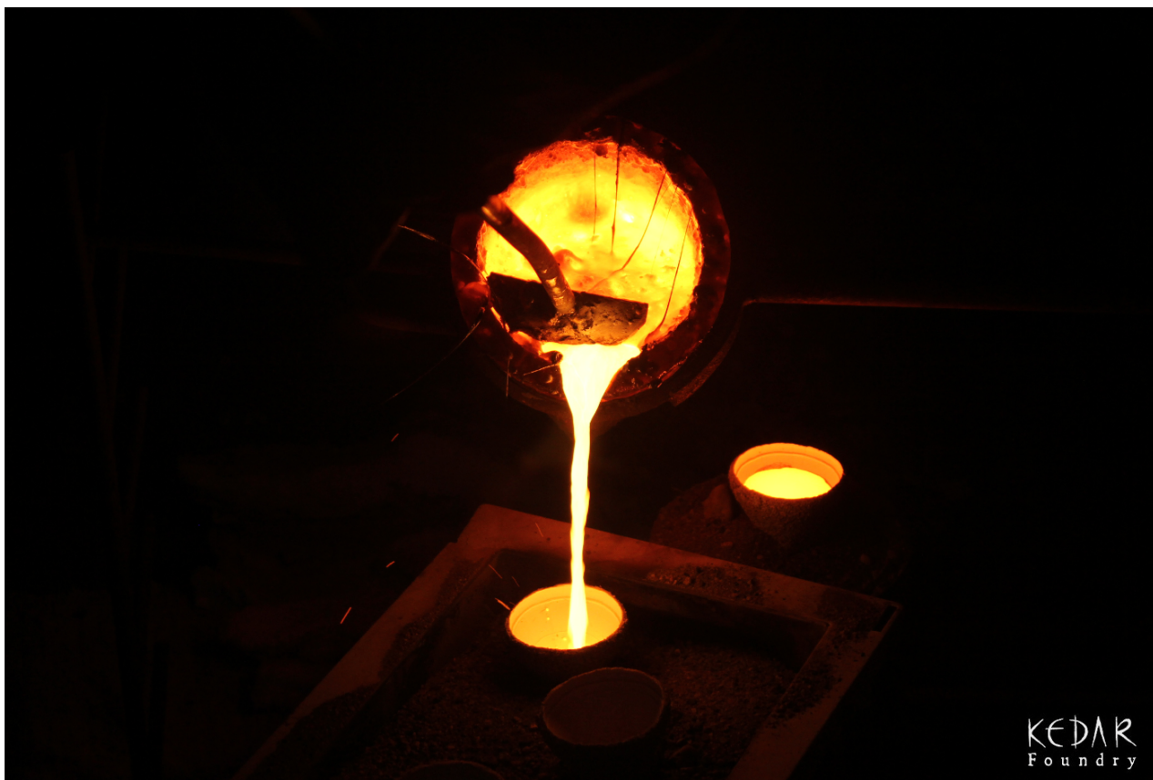
Obr. 2: Lití bronzu do keramických forem
