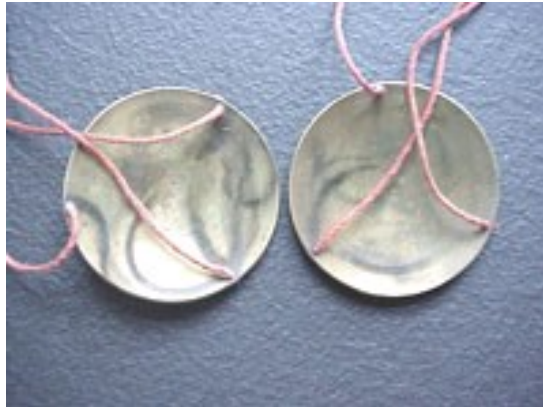
Černání stříbra po kontaktu s vlněným provázkem
