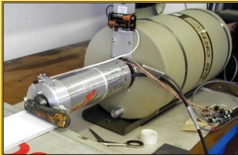
Si(Li) detektor - chlazený kapalným dusíkem
