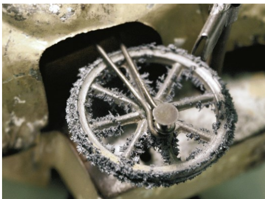
Poškození vlivem kyseliny mravenčí (vlevo) a octové (vpravo)
