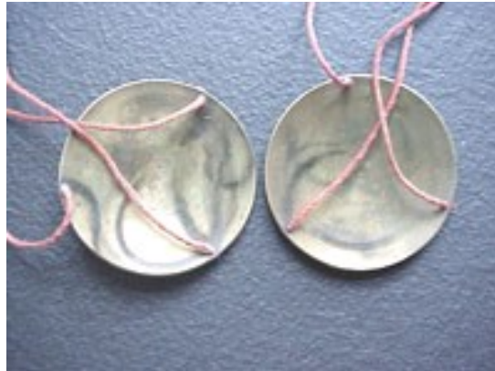
Černání stříbra po kontaktu s vlněným provázkem
