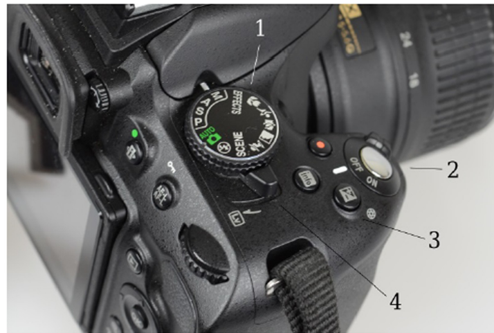
Obr. 8a a 8b. Ovládací prvky na těle fotoaparátu: 1 – volič expozičních režimů, 2 – hlavní vypínač a spoušť, 3 – tlačítko korekce expozice/clona (u tohoto modelu je nutné držet toto tlačítko zmáčknuté pro změnu nastavení clony v režimu M), 4 – přepínač živého náhledu, 5 – tlačítko menu nastavení fotoaparátu, 6 – tlačítko zobrazení a nastavení informací (k rychlému nastavení kvality snímku, režimu vyvážení bílé, hodnoty ISO, režimu expozice, atd.), 7 – příkazový volič (slouží k nastavení clony a expozice v režimech S, A a M), 8 – tlačítko přehrávání, 9 – multifunkční volič (přepínání mezi položkami na displeji), 10 – tlačítka pro zvětšení/zmenšení výřezu záběru, 11 – výklopný displej.
