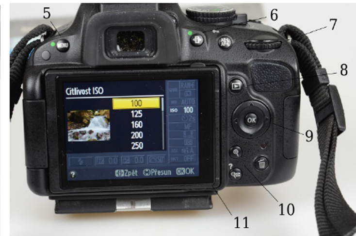
Obr. 8a a 8b. Ovládací prvky na těle fotoaparátu: 1 – volič expozičních režimů, 2 – hlavní vypínač a spoušť, 3 – tlačítko korekce expozice/clona (u tohoto modelu je nutné držet toto tlačítko zmáčknuté pro změnu nastavení clony v režimu M), 4 – přepínač živého náhledu, 5 – tlačítko menu nastavení fotoaparátu, 6 – tlačítko zobrazení a nastavení informací (k rychlému nastavení kvality snímku, režimu vyvážení bílé, hodnoty ISO, režimu expozice, atd.), 7 – příkazový volič (slouží k nastavení clony a expozice v režimech S, A a M), 8 – tlačítko přehrávání, 9 – multifunkční volič (přepínání mezi položkami na displeji), 10 – tlačítka pro zvětšení/zmenšení výřezu záběru, 11 – výklopný displej.
