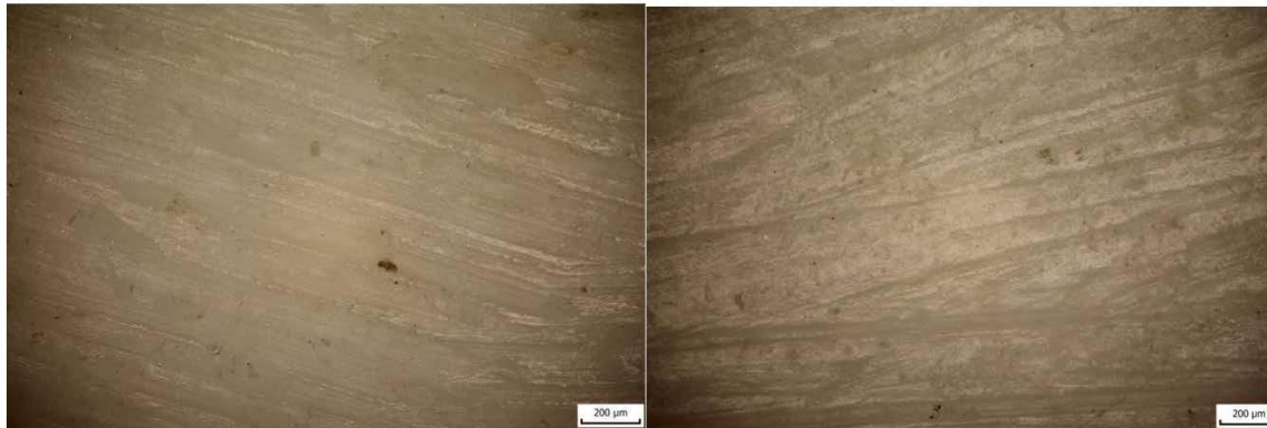
Obr. 2. 5 – záměrná (v tomto případě výrobní) striace při úpravě povrchu parohového experimentálního vzorku – vlevo za pomoci nože, vpravo pilníku (100x zvětšeno, fotografie autorky)
