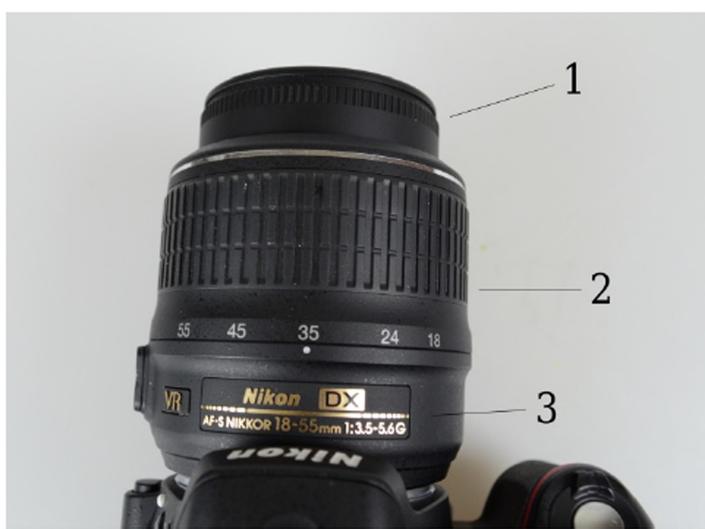
Obr. 6a a 6b. Základní ovládací prvky na objektivu: 1 – ostřicí kroužek, 2 – kroužek pro nastavení ohniskové vzdálenosti (zoom), 3 – informace o modelu objektivu s vyznačením (rozsahu) ohniskové vzdálenosti a (rozsahu) světelnosti, 4 – posuvné tlačítko pro automatické/ruční ( manual ) ostření, 5 – posuvné tlačítko funkce redukce vibrací ( vibration reduction ).
