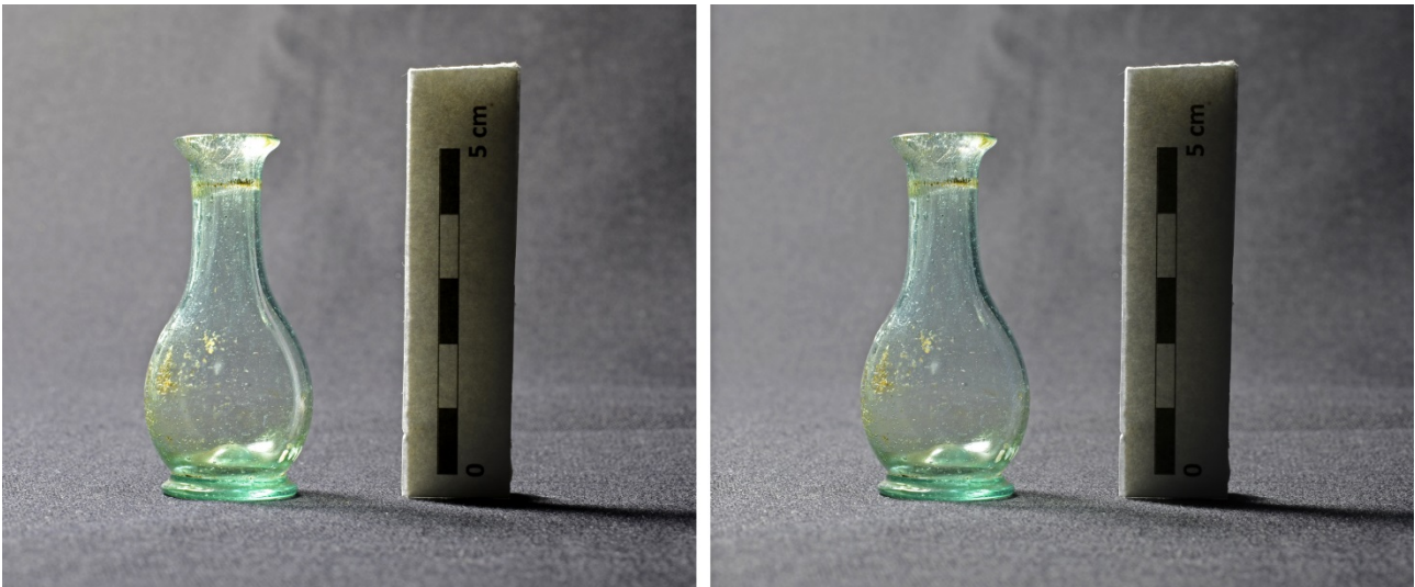
Obr. 23. Vliv polarizačního filtru na skelný lesk: Vlevo skleněná lahvička vyfocená bez použití filtru, vpravo stejný záběr s polarizačním filtrem, který lesk utlumil a v některých místech zcela eliminoval.
