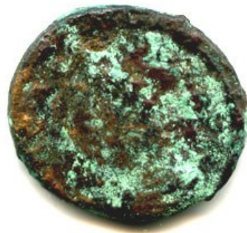
Aktivní koroze slitin mědi – nemoc bronzů
