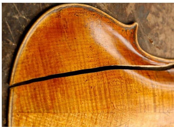
Praskání dřeva při nízké RV
