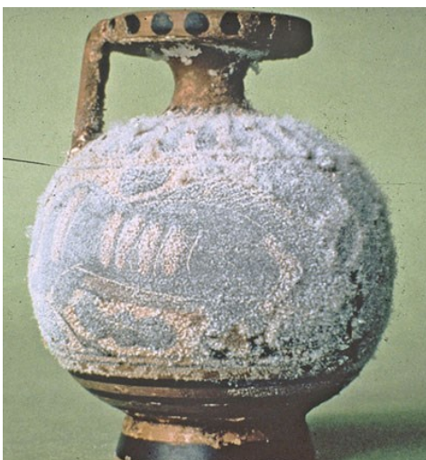
Solný výkvět na keramice při nízké RV
