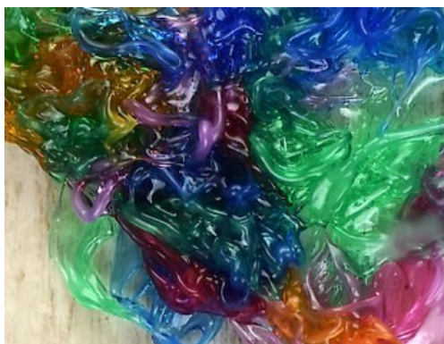
Poškození plastů působením vysoké T
