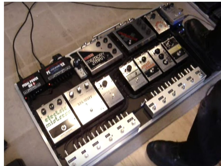
obr., sériově zapojená efektová zařízení pro ovládání nohou, f. Electro-Harmonix, cca 70.léta, někdy jako tzv. „krabičky“, zdroj: archiv autora a f. Electro-Harmonix
