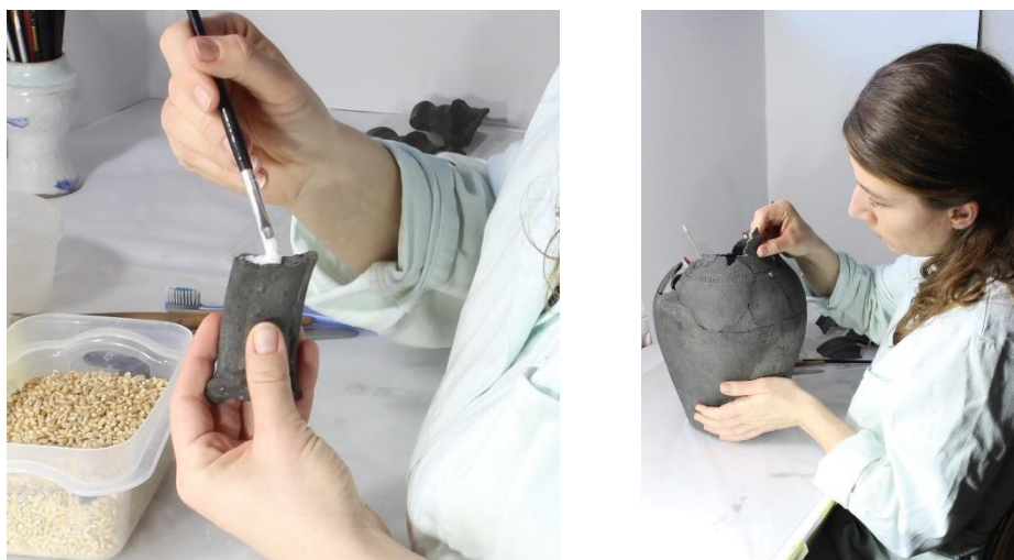
Obr. 9.12. Ukázka způsobu lepení.
