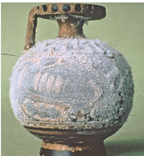
Solný výkvět na keramice při nízké RV
