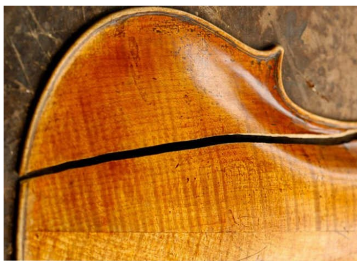
Praskání dřeva při nízké RV
