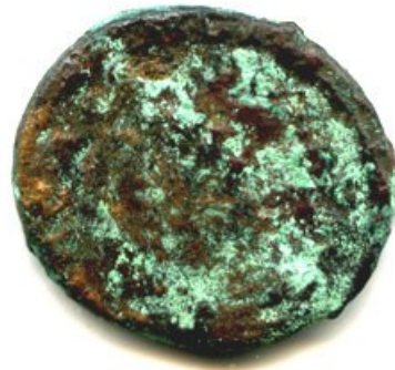
Aktivní koroze slitin mědi – nemoc bronzů
