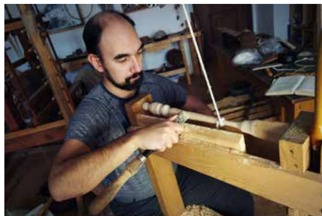
Obr. 3. Experimentální výroba soustruženého vřetena na pružinovém soustruhu. Foto Petra Vidomusová 2021, Muzeum Novojičínska
