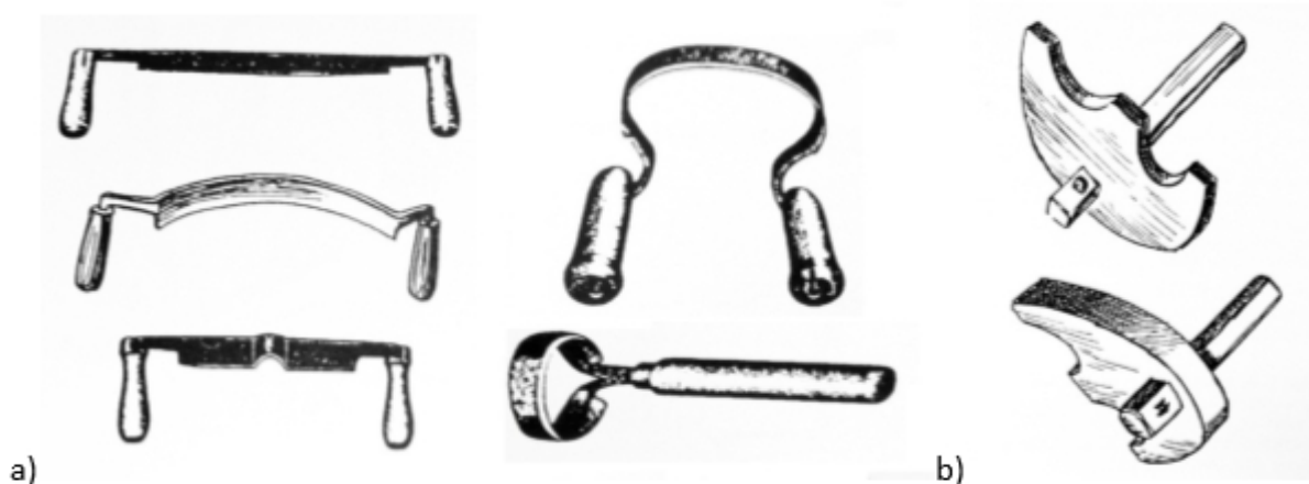
Nástroje používané bednáři: a) různé druhy požízů, b) útorník
