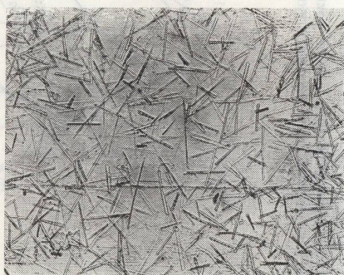
Obr. 79. Mikrosnímky krystalů vyloučených tepelnou expozicí ve skle (zvětš. 100krát) a — cristobalit, b — devitrit, c — wollastonit, d — diopsid
