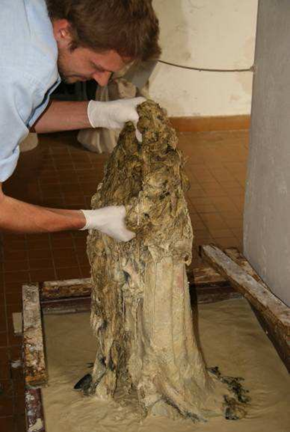
Proces alkalického loužení ve vápenném mléce. Foto: BcA. Radomír Slovík - Archiv Fakulty restaurování Univerzity Pardubice.
