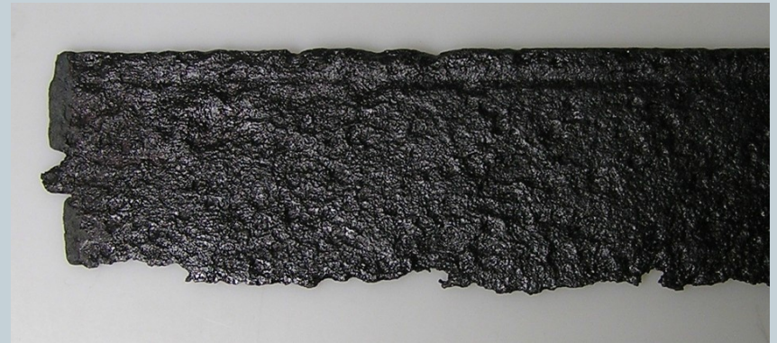
Část tesáku před a po tanátování [7]
